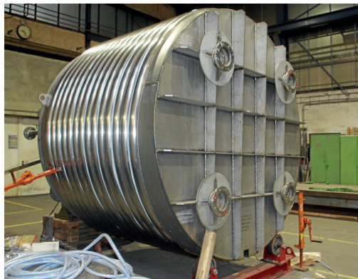
Bei den von LOHSE hergestellten Mischbehältern kommt zum Beispiel die chemisch beständige und hochwärmefeste Nickel-Chrom-Molybdän-Legierung 2.4605 zum Einsatz.
