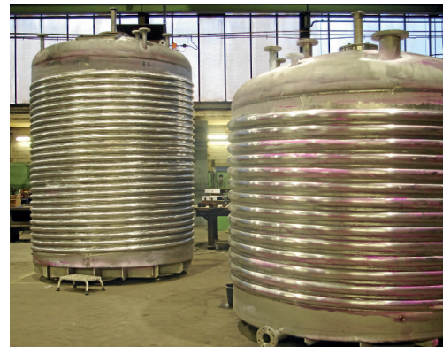
Bei den von LOHSE hergestellten Mischbehältern kommt zum Beispiel die chemisch beständige und hochwärmefeste Nickel-Chrom-Molybdän-Legierung 2.4605 zum Einsatz.
