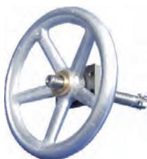
Handrad mit steigender Spindel, linksgängiges Trapezgewinde, mit Anschlaghülse.
