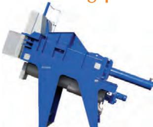
Zur Entwässerung von Reject aus dem Stofflöser oder Müllaflöser. Metall- oder Kunststoffdrähte werden beim Entwässerungsvorgang gleichzeitig abgeschnitten. Durch einen Schieber werden die gepreßten Abfälle ausgeworfen.
