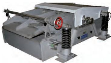
Vibrationsortierer eignen sich durch den wahlweisen Einsatz von gelochten oder geschlitzten Siebblechen für alle in der Papierindustrie vorkommenden Sortieraufgaben sowohl im Dünnstoff- als auch im Dickstoffbereich.
