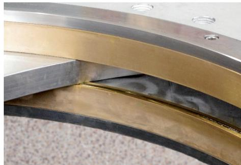
Gleitleisten und Gleitringe aus Bronze sorgen für einen reibungslosen Ablauf beim Öffnen und Schließen der Armaturen.
