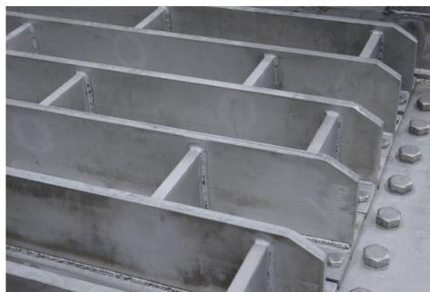
Nur durch stark verripptes Gehäuse können die für diese Größe extrem hohen Betriebsdrücke erreicht werden.
