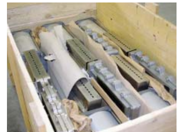
neuwertiger reparierter Schieber
