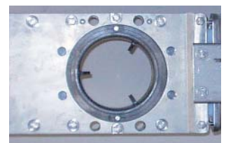
Minimierung des Verschleißes durch konischen Ring mit Bremsrippen
