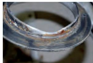
Minimierung des Verschleißes durch konischen Ring mit Bremsrippen
