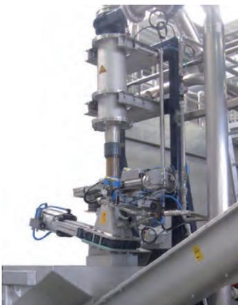
Sandabscheider werden zur Schwere- und Schmutzabscheidung aus Suspensionen eingesetzt. Drähte und Blechstücke, insbesondere kleine, körnige Partikel wie Glas- und Sandteilchen werden abgeschieden.
